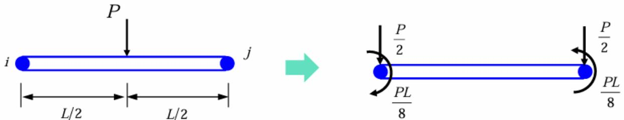
对于作用在梁上一点的力，我们可以采用 [Dirac 函数](#) 处理。对于上述情况，在梁上  $x = \frac{L}{2}$  处作用力  $F = P$ ，取  $\delta$  函数  $\delta\left(\frac{L}{2}\right)$ ，则
